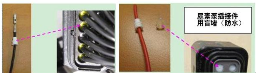
图 5-18 尿素计量泵电器接头防水示意图
