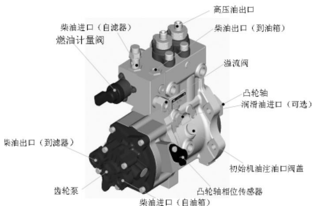
图2-4 CPN2.2型高压油泵外部结构
